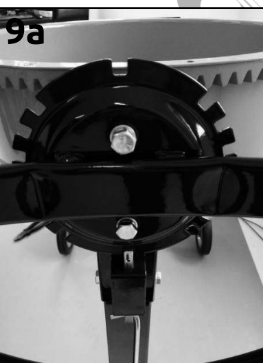
Βήμα 8: Τοποθετήστε τη ράβδο, τη ροδέλα M6, την ροδέλα ασφαλείας M5 και τα 2 παξιμάδια M5 με τη σειρά των εικόνων, σφίξτε τα 2 παξιμάδια M5 για να στερεώσετε τη ράβδο.
