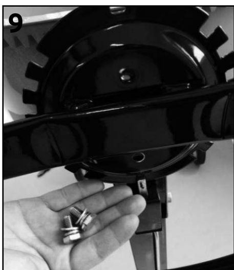
Βήμα 8: Τοποθετήστε τη ράβδο, τη ροδέλα M6, την ροδέλα ασφαλείας M5 και τα 2 παξιμάδια M5 με τη σειρά των εικόνων, σφίξτε τα 2 παξιμάδια M5 για να στερεώσετε τη ράβδο.
