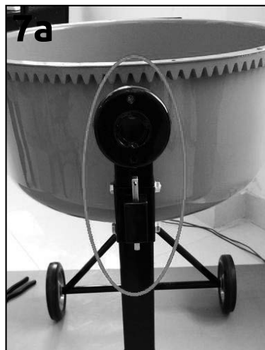
Βήμα 7: Τοποθετήστε το κάτω μέρος του τυμπάνου με την βοήθεια ενός άλλου ατόμου κρατώντας τις 2 πλευρές του καμπυλωτού βραχίονα δίνοντας προσοχή στα σημεία που βρίσκονται εντός των κύκλων.
