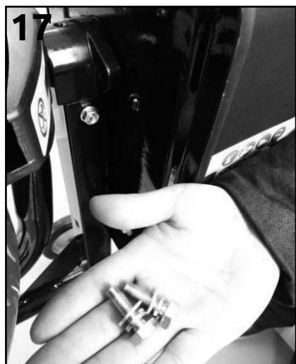
Βήμα 15: Τοποθετήστε 2 βίδες M8*60 και παξιμάδια στα σημεία που βρίσκονται εντός των κύκλων.
