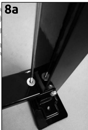
Βήμα 8: Τοποθετήστε τη ράβδο, τη ροδέλα M6, την ροδέλα ασφαλείας M5 και τα 2 παξιμάδια M5 με τη σειρά των εικόνων, σφίξτε τα 2 παξιμάδια M5 για να στερεώσετε τη ράβδο.
