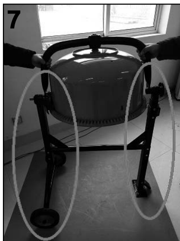
Βήμα 7: Τοποθετήστε το κάτω μέρος του τυμπάνου με την βοήθεια ενός άλλου ατόμου κρατώντας τις 2 πλευρές του καμπυλωτού βραχίονα δίνοντας προσοχή στα σημεία που βρίσκονται εντός των κύκλων.
