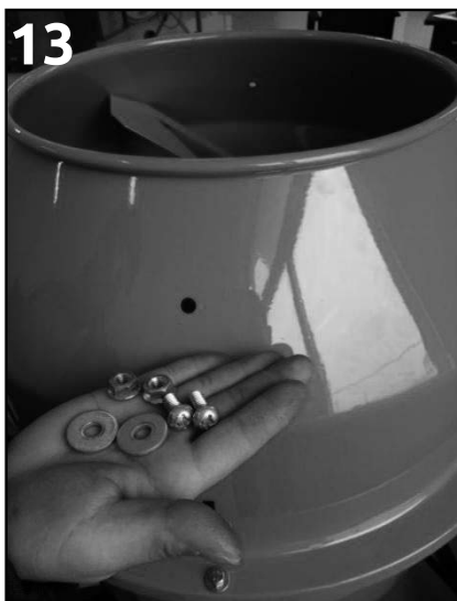
Βήμα 13: Τοποθετήστε 2 σετ βιδών M8*16 & ροδέλα M8 εξωτερικά και 2 παξιμάδια εσωτερικά για να στερεώσετε το πάνω μέρος των πτερυγίων ανάμειξης.
