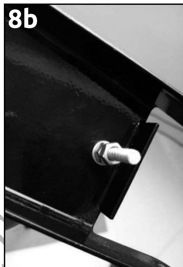
Βήμα 8: Τοποθετήστε τη ράβδο, τη ροδέλα M6, την ροδέλα ασφαλείας M5 και τα 2 παξιμάδια M5 με τη σειρά των εικόνων, σφίξτε τα 2 παξιμάδια M5 για να στερεώσετε τη ράβδο.
